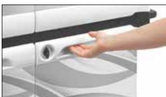
Porta con sistema di chiusura con chiave estraibile e maniglia ergonomica per apertura.
